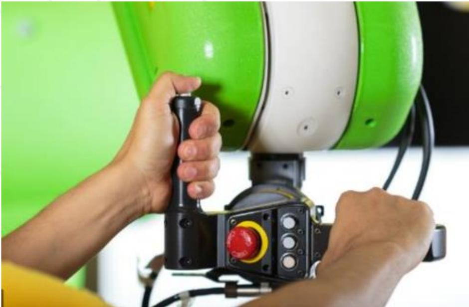
O método consiste em permitir que o operador mova o robô por dispositivo manual para transmitir comandos de movimento. No novo padrão, ele será chamado de equipamento de controle guiado manualmente. Os controles guiados manualmente devem ter um botão de parada de emergência.
