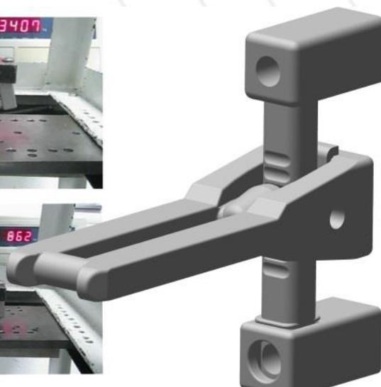
Ex. O atuador de TA do Fortress permanece intacto além de 4000 kg de carga; *um atuador típico quebra em torno de 700Kg.* Artigo de Fortress Interlocks É o excesso de dimensionamento, testes e dados rigorosos de 3 bilhões de horas de uso em serviço que fornece o laboratório de testes e certificação TÜV SÜD, a evidência de indicar o alguns tipos de intertravamento, como um intertravamento PLe sem o uso de um bloqueio secundário.
